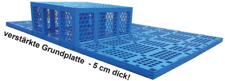
Die Grundplatte ist in der Regel auf verdichtetem, sickerfähigem Untergrund zu verlegen. Vlies ist nur in Ausnahmefällen auf die Versickerungsfläche aufzubringen. Durch die besondere Oberfläche der Grundplatte sind Reinigungsarbeiten optimal durchführbar.
