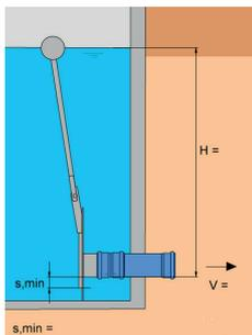
Die Durchflussblende wird entsprechend dem gewünschten Drosselabfluss speziell gefertigt. Bei Bestellung muss daher der Drosselabfluss V und die Höhe H angegeben werden.
