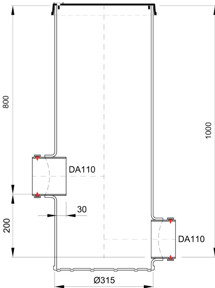
**PVC - Probeentnahmeschacht DN 315**
