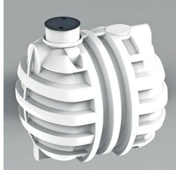
**PE-Trinkwasserspeicher** aus lebensmittelechtem Polyethylen (PE) für den Einbau ins Erdreich mit tagwasserdichter Abdeckung. Der PE-Tank bietet viele Anbohrflächen zur Montage diverser Gewindestutzen für Zulauf, Überlauf, Entnahme sowie Entleerung.
